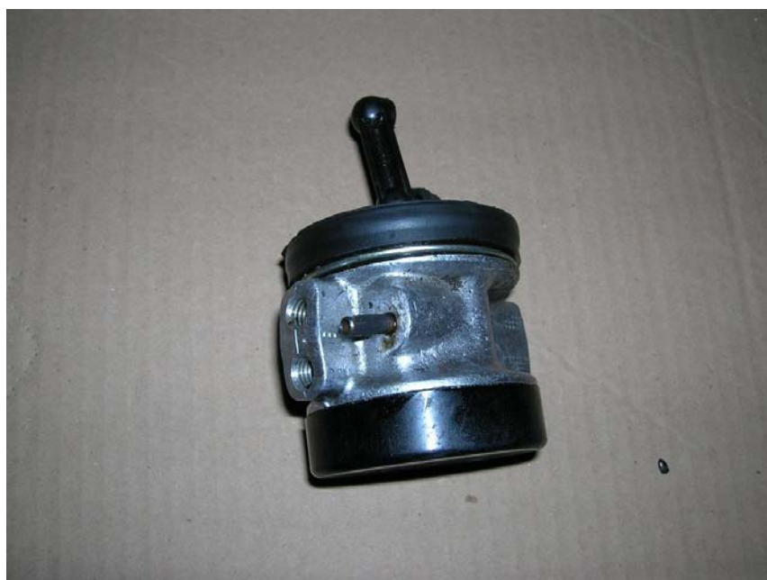
On commence a enlever la coupelle en plastique rigide d'étanchéité a la main
