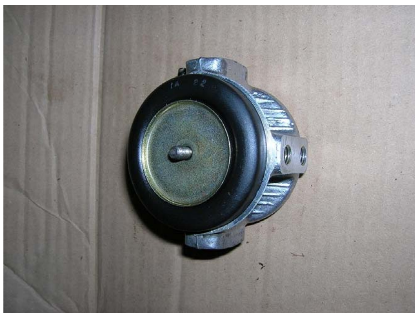
On place la rondelle (noté qu'il n'y en a pas de l'autre côté)
