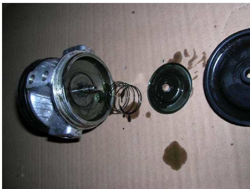
On dégage le circlips avec un petit tournevis (drole de couleur a l'interieur)
