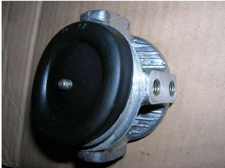
Mise en place de la coupelle
