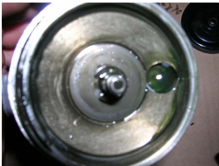
On enleve aussi le clapet (roudelle très fine)
