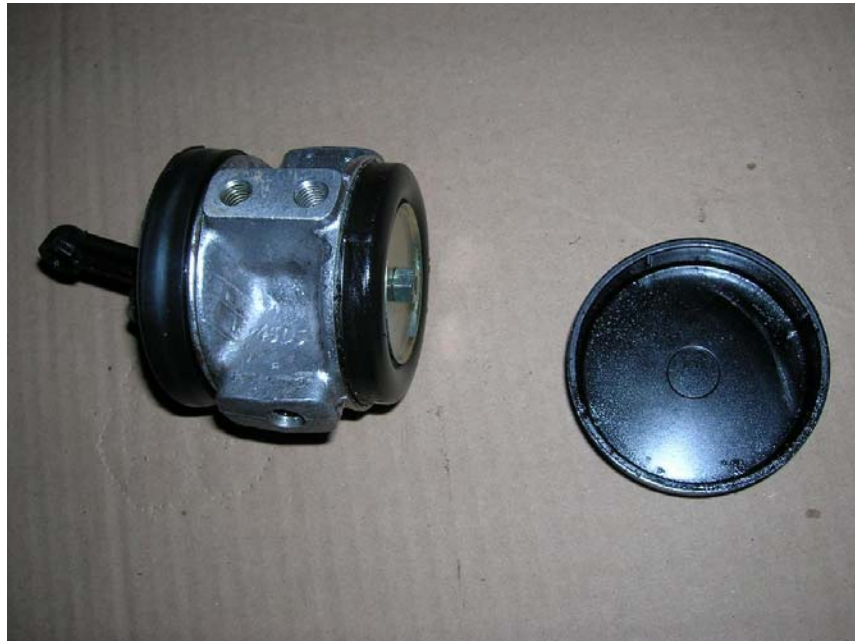
avec une cle de 8 on enleve l'ecrou et la rondelle
