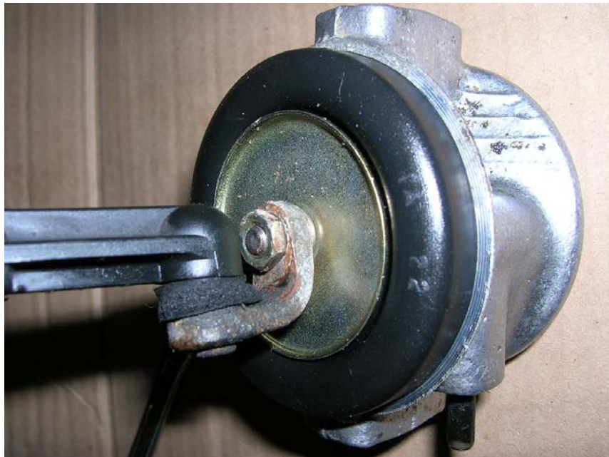
Mettre le correcteur dans un étau en le protégeant lubrifier la membrane et poser l'anneau (ca rentre tout seul)
